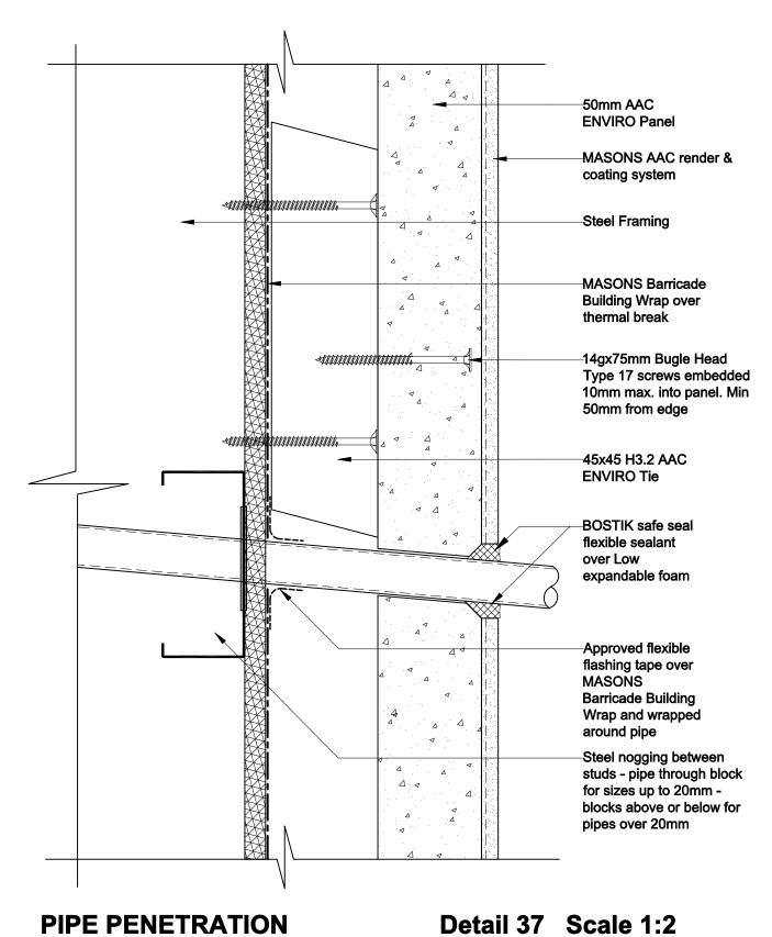
MASONS ENVIRO AAC ON 45mm CAVITY STEEL FRAME
