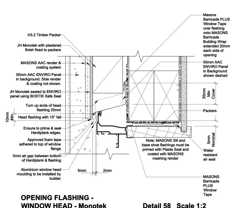
MASONS ENVIRO AAC ON 45mm CAVITY TIMBER FRAME
