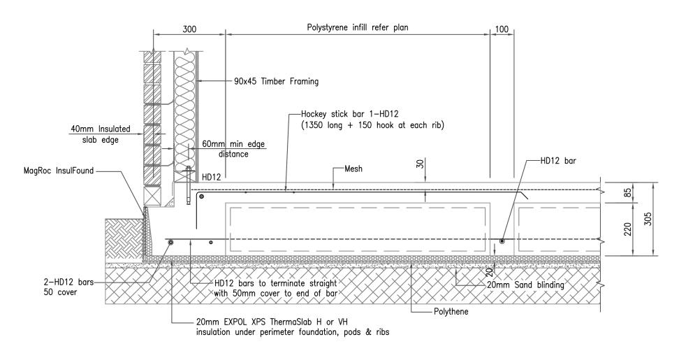
HEAVY WEIGHT CLADDING ALLIED SUPERSLAB WARMEDGE + UNDERSLAB INSULATION DETAIL
