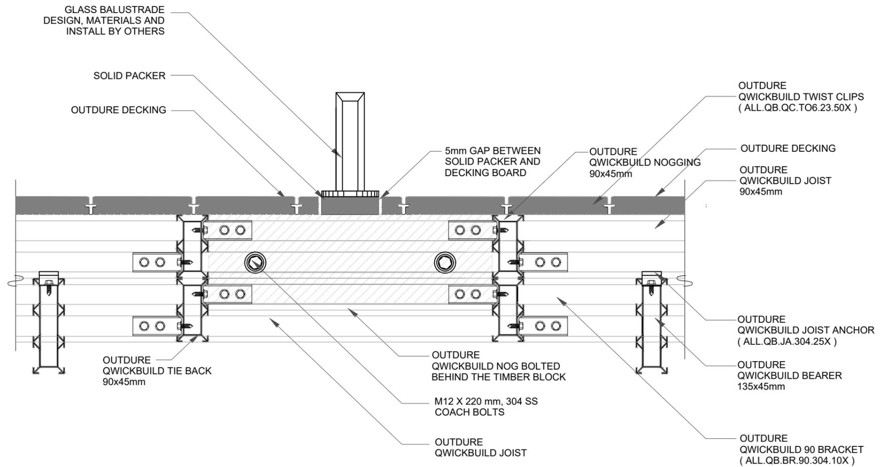
**3** QB-G3. BALUSTRADE PARALLEL TO JOIST DIRECTION FOR 90mm JOIST ( SECTION VIEW 1)
