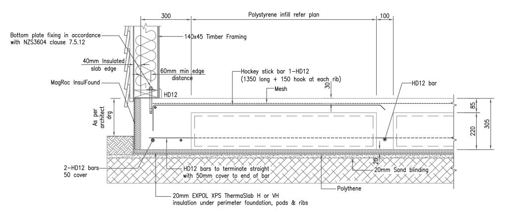
LIGHT WEIGHT CLADDING ALLIED SUPERSLAB WARMEDGE + UNDERSLAB INSULATION DETAIL
