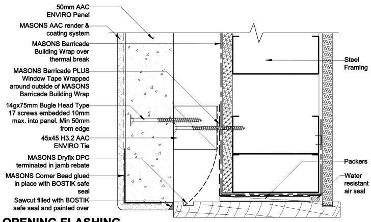
**OPENING FLASHING GARAGE DOOR - Jamb**
