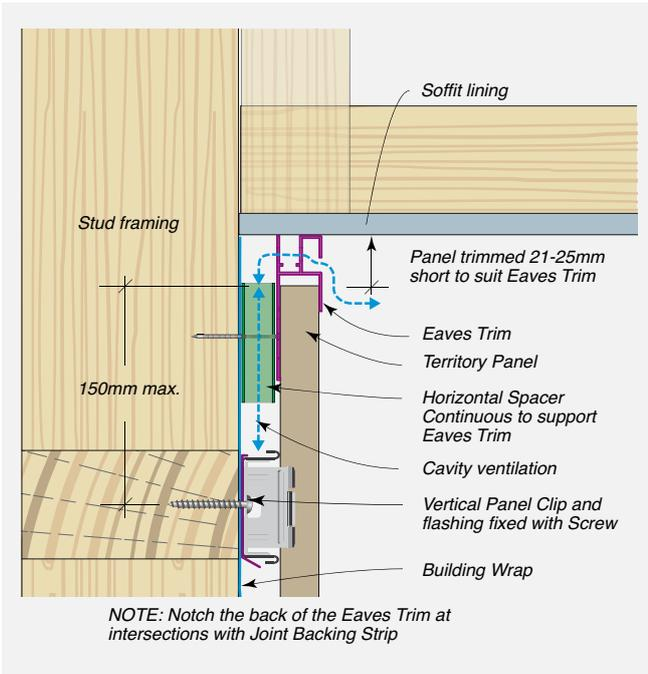
**FIGURE 8.07** Soffit Detail
