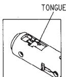
TO LOCK PLUNGER UNIT #6 INTO SPINDLE.
