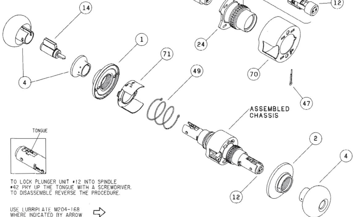
TO LOCK PLUNGER UNIT #12 INTO SPINDLE #42 PRY UP THE TONGUE WITH A SCREWDRIVER. TO DISASSEMBLE REVERSE THE PROCEDURE.
