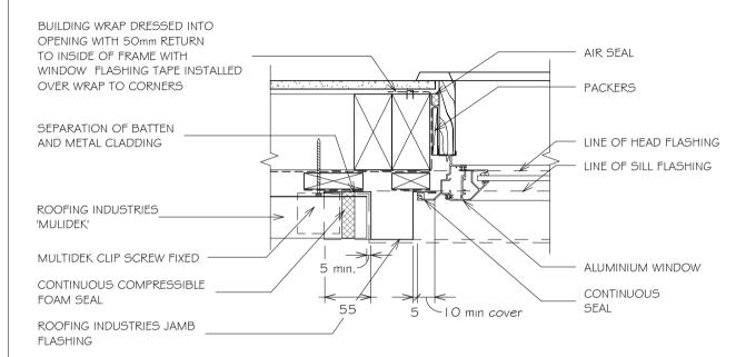
SOAKER FLASHING MAY BE REQUIRED IN WIND ZONE GREATER THAN VERY HIGH. BACK TRAY TO RUN FROM TOP OF HEAD FLASHING TO GROUND OR FXIT POINT
