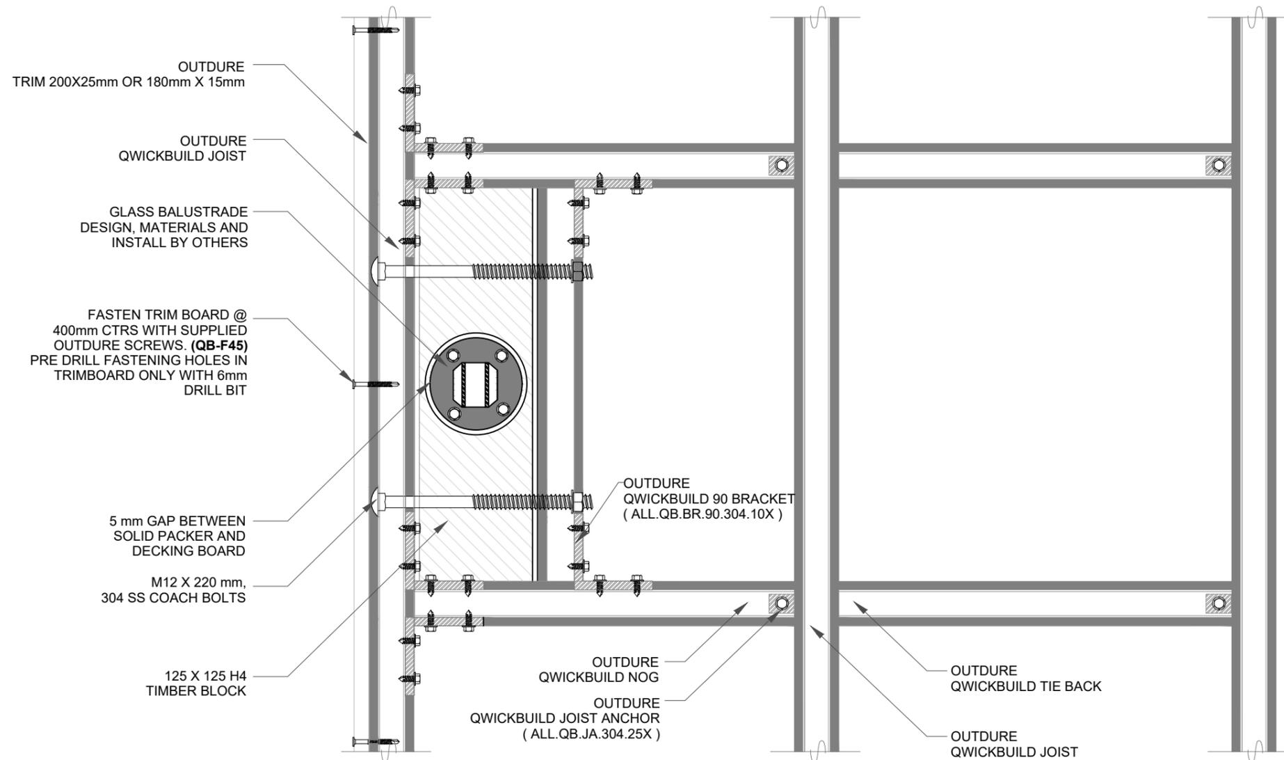
**2 QB-G3. BALUSTRADE PARALLEL TO JOIST DIRECTION FOR 90mm JOIST ( PLAN VIEW )**
