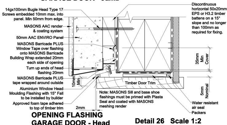
**MASONS ENVIRO AAC ON 20mm CAVITY** TIMBER FRAME
