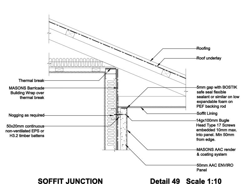
**MASONS ENVIRO AAC ON 20mm CAVITY** STEEL FRAME
